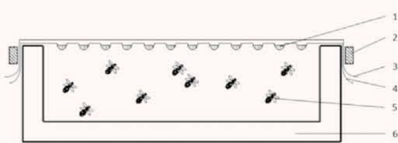
松毛虫赤眼蜂寄生人工卵卡装置的示意图
